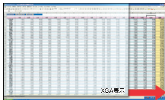
XGAに比べ、約1.3倍の情報量により、表計算データなどを見やすく表示することが可能。
