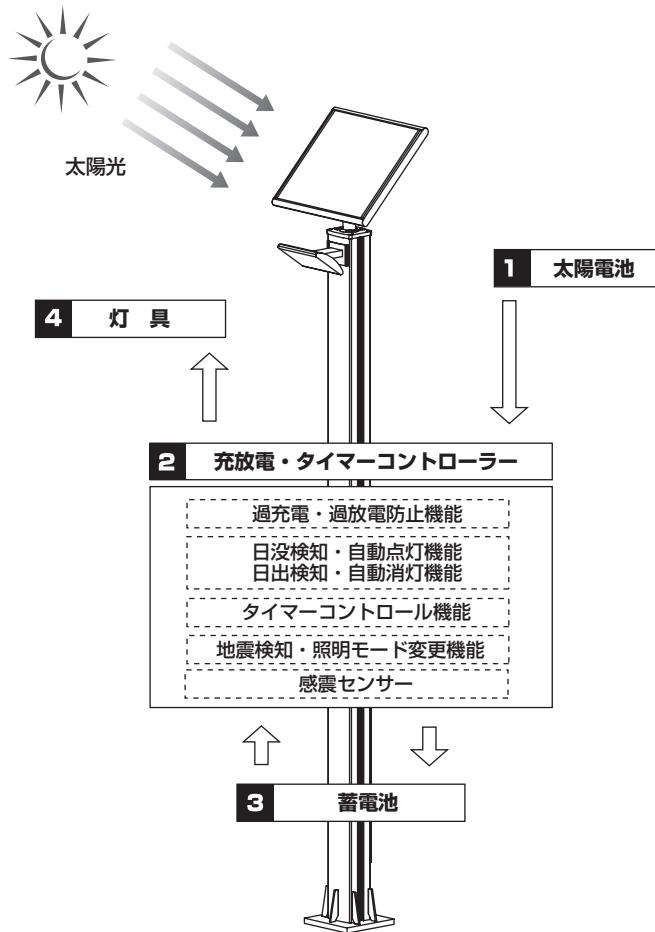
**1 太陽電池** 太陽の光エネルギーを直接電気エネルギーに変換します。また、周囲が暗くなると出力電圧が低下する特性を利用し、灯具を点灯させるセンサーのはたらきもします。
