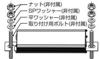
※施工中に無理に力を加えると取付金具が変形するおそれがあります。(過度な変形は器具落下の原因となります。)
