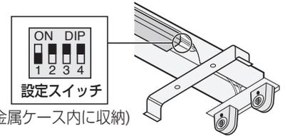
**設定方法** スイッチ1をONにして、電源を投入する。(初期照度補正を初期化する場合は、スイッチ2と3をOFF、スイッチ4をONにして電源を投入した後、元に戻す)
