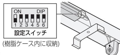
**設定方法** スイッチ1をONにして、電源を投入する。(初期照度補正を初期化する場合は、スイッチ5をONにして電源を投入した後、OFFにする)
