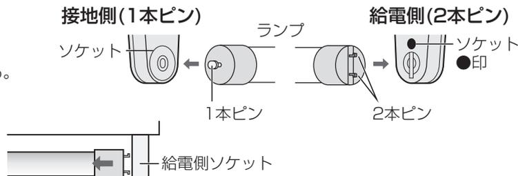
③発光部が照射方向となるように、90°回転させて取り付けてください。
