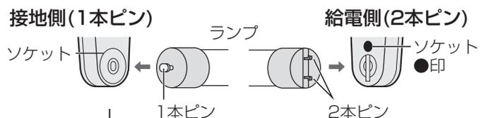
②ランプの2本ピン側を矢印の方向(1本ピン側)へ押さえながら、給電側ソケット(●印付き)に挿入する。
