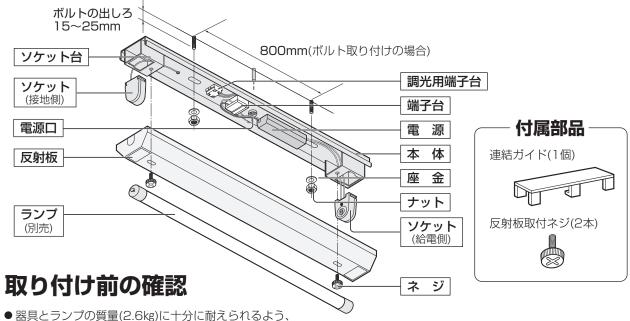
● 器具とフンノの質量(2.6kg)に十分に耐えられるよう、 ボルト取付部の強度および天井材の強度を確保する。取付ボルトは、W3/8、またはM10を使用する。
