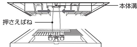
③ イオン発生機カバーを天井に向かって手で押し上げ、押さえばねの力で天井に押し付けます。
