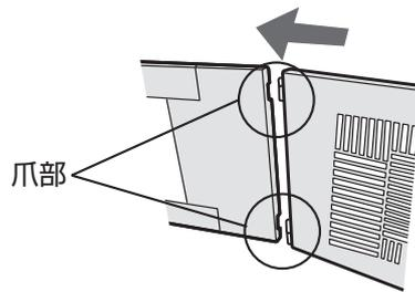
② イオン発生機カバーの押さえばね先端を手でつまみ、本体溝に挿入し引っ掛けます。
