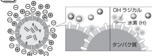
カビ菌やウイルスの表面に付着すると、非常に酸化力の強いOHラジカルに変化し、瞬時に表面のタンパク質から水素(H)を抜き取りタンパク質を分解。
