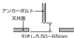
※アンカーボルト600mm間隔で施工する場合は、ノックアウト部(600mm間隔)に穴を開け(内側からドライバーなどで打ち抜く)使用しない800mmの取付穴は、虫や異物の侵入を防止するため、テープなどで必ず閉じてください。
