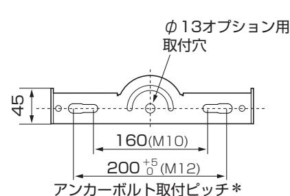
\* M12アンカーボルトの場合は取付ピッチ200mm
