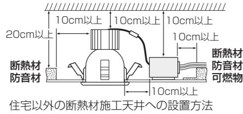
住宅以外の断熱材施工天井への設置方法
