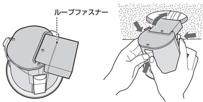
2 取付ばね(3力所)をヒートシンクの方へ押さえたまま、埋込穴に端子台側から押し込み、ゆっくりと押し上げて確実に取り付ける。
