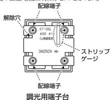
3 調光信号線をはずす場合は、電源を切り、解除穴をマイナスドライバーで直角に押しながら引き抜く。 (ドライバーを傾けると調光端子台を破損するおそれがあります)
