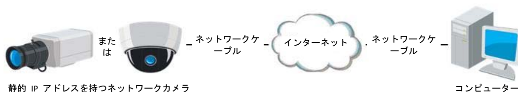
図 2-5 静的 IP を持つカメラによる直接アクセス
