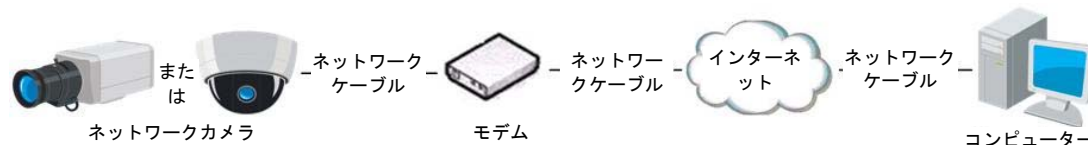
図 2-6 動的 IP を持つカメラによるアクセス
