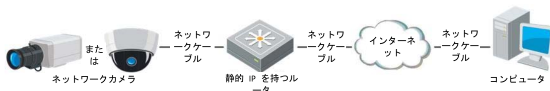
図 2-4 静的 IP を持つルーターを経由したカメラへのアクセス
