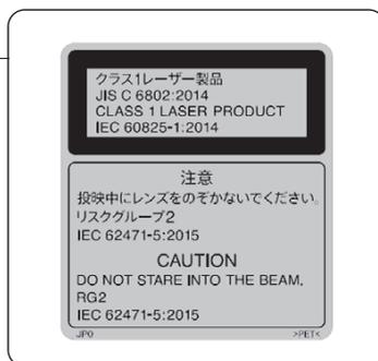
本機は IEC 60825-1:2014 及び JIS C 6802:2014 に適合したクラス 1 レーザー製品です。
