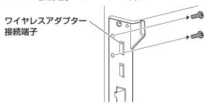
2. ワイヤレスアダプター(付属)をワイヤレスアダプター接続端子に挿入する。
