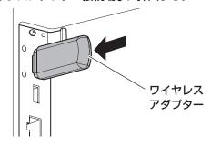
3. ワイヤレスアダプターカバー(付属)を付け、手順1で外したネジで固定する。
