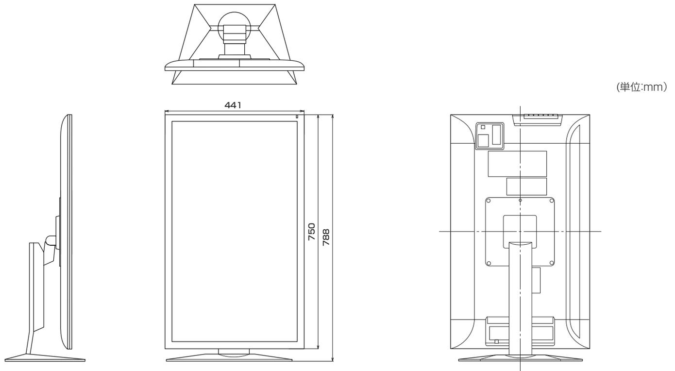
※ VESA 規格の金具の取り付けには、M6 ネジで、長さが取り付け金具の厚さ +8 ~ 10mm のものを使用してください。
