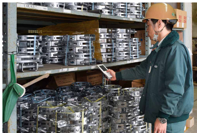
棚に貼ったバーコードをスキャンすることで、資材名を自動入力
