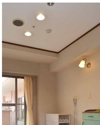
一人用居室はダウンライト、二人用居室にはシーリングライトを導入。枕元にはLED電球を設置
