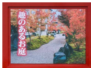
6mm幅の狭ピッチモジュールで文字情報も高精細に表示
