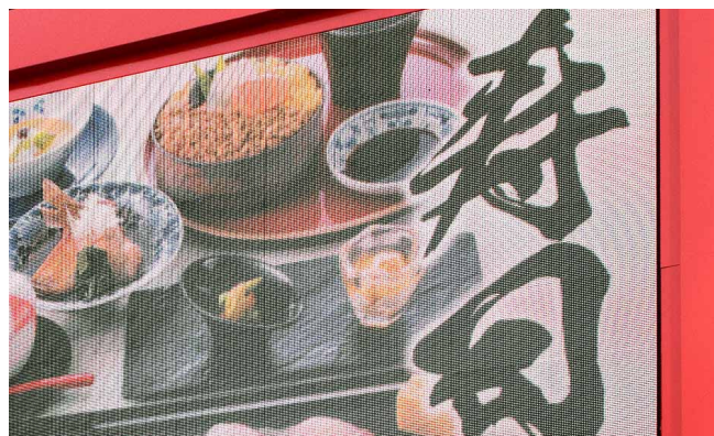
6mm幅の狭ピッチモジュールで文字情報も高精細に表示
