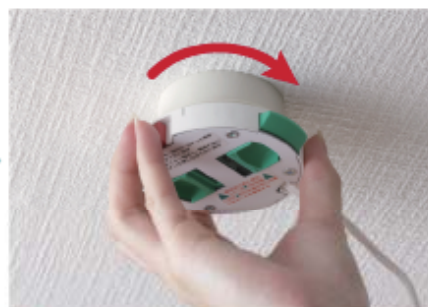
2 配線器具とアダプターの位置を合わせて「カチッ」と音がするまで、時計回りに回して取り付けます。
