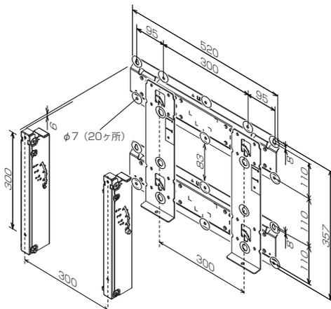
○印のねじ孔(20ヶ所)を、市販のねじ(径6mm)で固定します。
